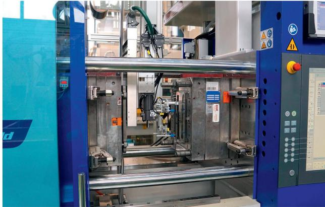
Wegen der relativ hohen Steifigkeit und der hohen Erweichungstemperaturen eignen sich die PC-Folien nicht für die Direktverarbeitung auf der Spritzgießmaschine, sondern müssen außerhalb derselben durch Tiefziehen und nachfolgende Bearbeitungsschritte zu Einlegteilen konfektioniert werden. Im Spritzgießwerkzeug hinterspritzt werden daraus Instrumententafeln oder Mittelkonsolen für Automobile.
