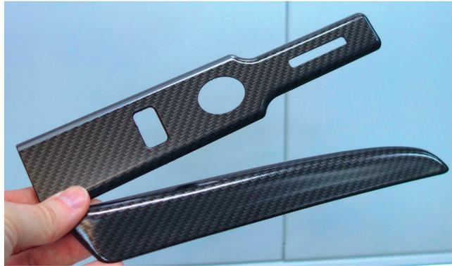
**Bild 4.** Beispiele aus dem aktuellen Versuchsprogramm bei Leonhard Kurz zur Erweiterung der Ecken- und Radienformung mit unterschiedlichen Folien (© R. Bauer)
